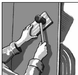
Установите плиту на стену; с помощью резинового молотка пригоните ее к стене и выровняйте.
