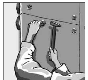
В просверленные отверстия в точках цементования вбейте дюбели.
