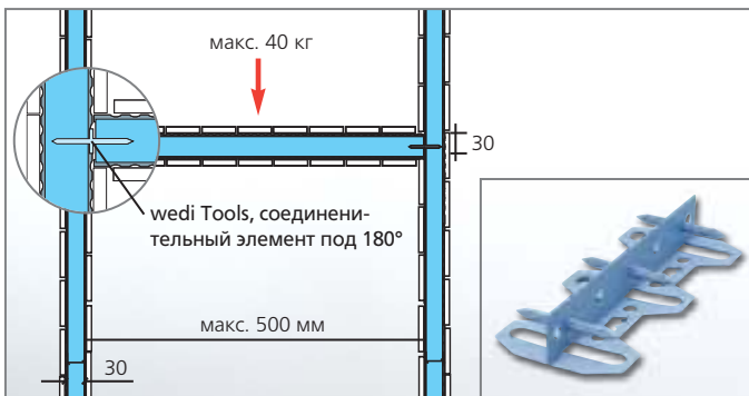
Допустимая нагрузка на соединительный элемент wedi Tools (180°) и пример установки.
